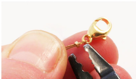
Wireklemmen klemmes til med tang.
